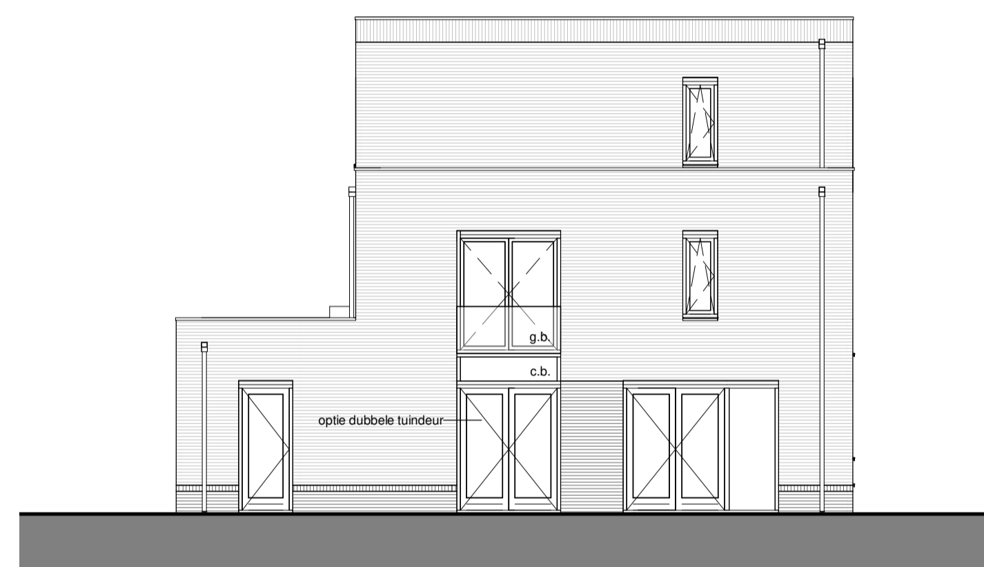
Achtergevel - optie: dubbele tuindeur
